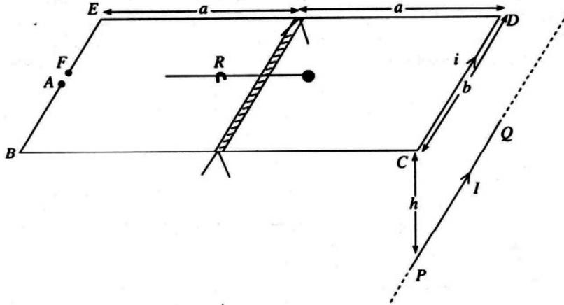
A සහ F කම්බි දෙකෙළවර එකිනෙකට ස්පර්ශ නොවන සේ පිහිටන ABCDEF නම් දෘඩ, සෘජුකෝණාස්‍රාකාර කම්බි රාමුවකින් සාදන ලද ධාරා තුලාවක ඇටවුමක් රූපයේ පෙන්වා ඇත. ආරෝහක සැකැස්මක් දරා සිටින, පරිවාරක ද්‍රවයකින් සෘජු සැහැල්ලු තීරුවක් රූපයේ පෙන්වා ඇති ආකාරයට කම්බි රාමුවේ මැදට සවිකර ඇත. R ආරෝහකයේ පිහිටීම සිරුමාරු කිරීම මගින් මෙම ඇටවුම පිහි තුඩු දෙකක් මත පළමුව තිරස්ව සංතුලනය කර ඇත. බාහිර ධාරා ප්‍රභවයක් පිහි තුඩුවලට සම්බන්ධ කිරීමෙන් කම්බි රාමුව හරහා ධාරාවක් ගැනීමට හැකිවන ආකාරයට පිහි තුඩු සහ කම්බි රාමුව ස්පර්ශ වී ඇත.
